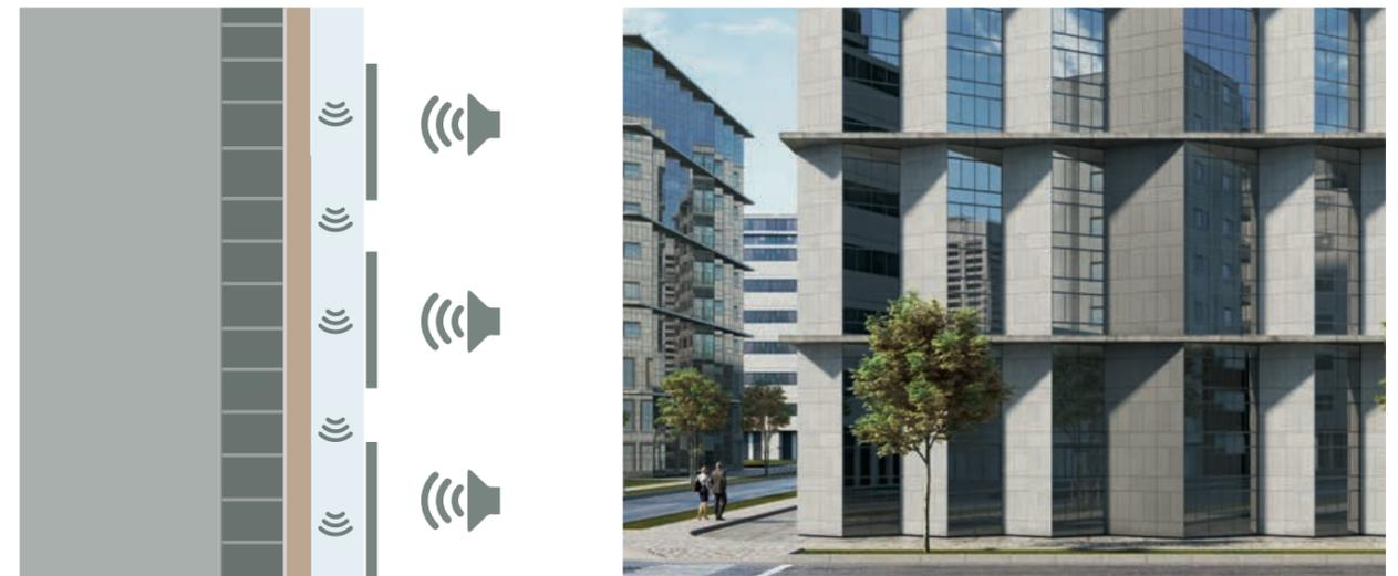
El sistema de fachada ventilada mejora el aislamiento acústico del conjunto, y cuando el aislante instalado tiene además propiedades aislantes acústicas, éste ayuda a reducir la transmisión de ruido aéreo a través de la parte ciega de la fachada. La lana mineral además hace que disminuya la frecuencia de resonancia propia del sistema.
